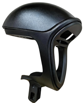
头部外壳总成 6061 CNC 加工 表面喷砂黑色阳极氧化
