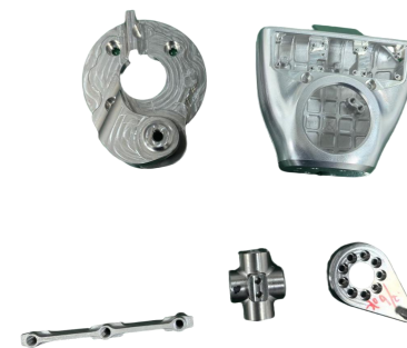
机器人关节传动组件, 铝合金 CNC 加工
