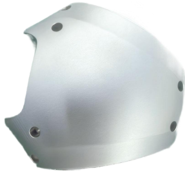
末端腕关节外观防护壳体 6061 CNC 五轴加工, 表面喷砂本色阳极氧化
