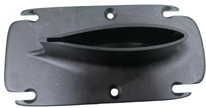
关节外侧装饰防护盖板 061 CNC 加工 表面喷砂黑色阳极氧化
